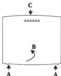
Öffnen der TK-Anlage: »C« ist die Vorderseite der TK-Anlage. Ziehen Sie die zwei gekennzeichneten Kunststoff-Federn »A« nach außen, bis der Deckel ausrastet. Heben Sie ihn »B« anschließend vorsichtig nach hinten ab. Anschließend lässt er sich leicht nach oben abheben. Unter dem Gehäusedeckel wird dann das Anschlussklemmenfeld sichtbar.
