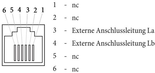
Die Anschlüsse La und Lb sind galvanisch von der Schaltung der TK-Anlage getrennt.
