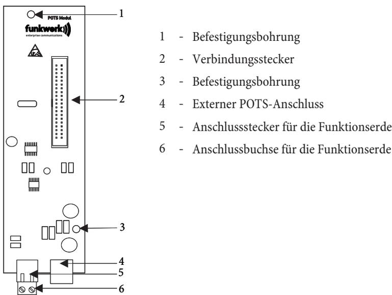
Die Verbindung zur TK-Anlage erfolgt über das mitgelieferte Flachbandkabel. Der Externe analoge Anschluss und der Anschluss der Funktionserde erfolgt über die Anschlüsse auf dem Modul. Dazu müssen die zwei markierten Durchbrüche im Gehäuse der TK-Anlage herausge-
