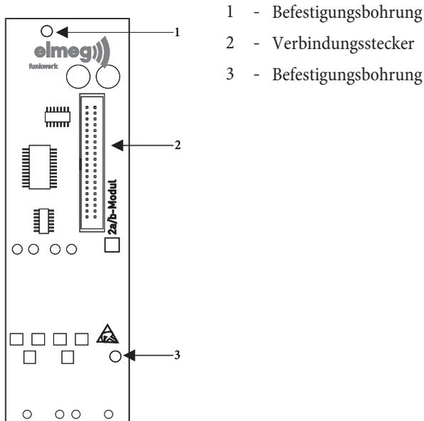
Die Verbindung zur TK-Anlage erfolgt über das mitgelieferte Flachbandkabel. Der Anschluss der zwei analogen Teilnehmer erfolgt an den Anschlussbuchsen a/b5 und a/b6 der TK-Anlage.
